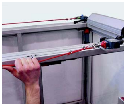
10. Überprüfen Sie die Funktionalität des Schalters, bevor Sie die Maschine in Betrieb nehmen.
